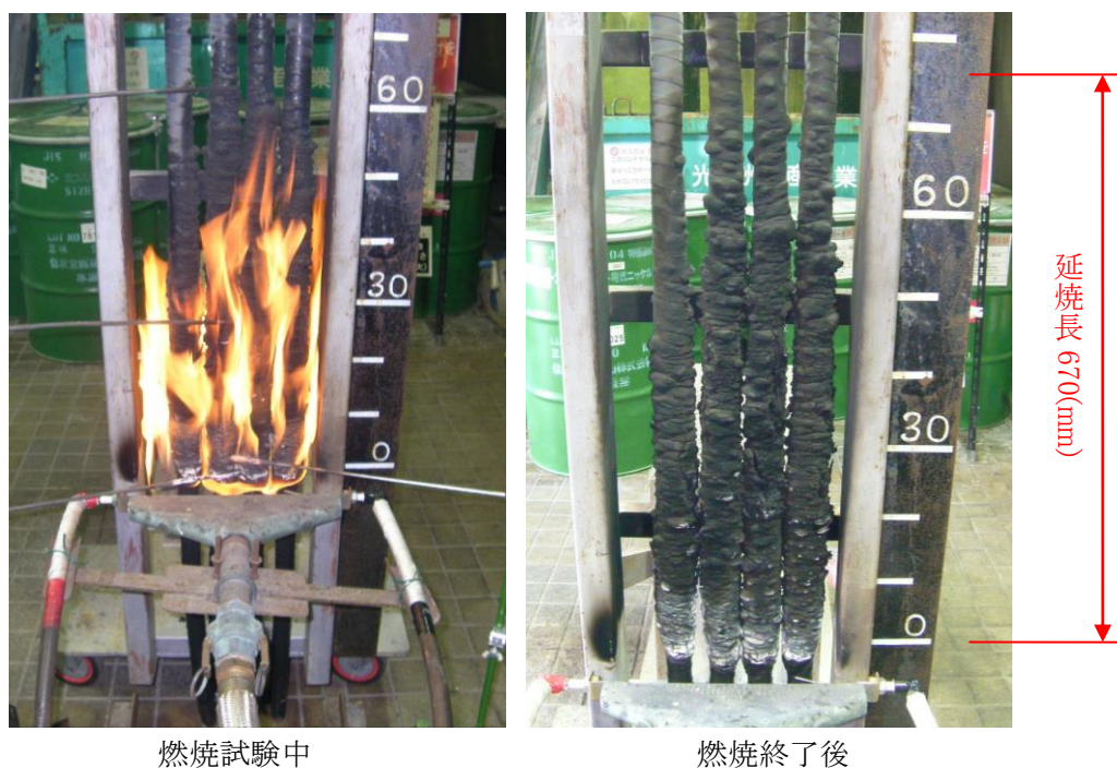
図-1 垂直トレイ燃焼試験
