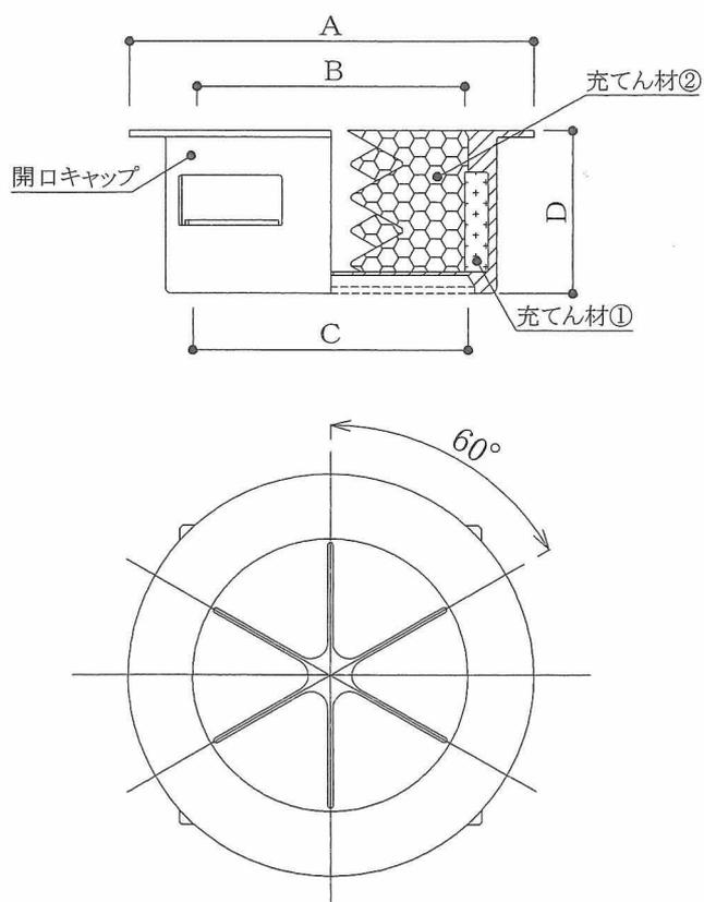
開口キャップの詳細図(形状の一例)
