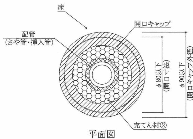
配管(さや管・挿入管)が貫通する例
