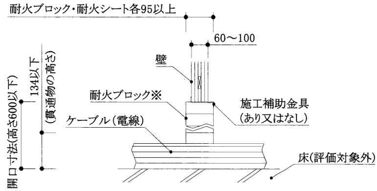
断面図(床置き工法の例)
