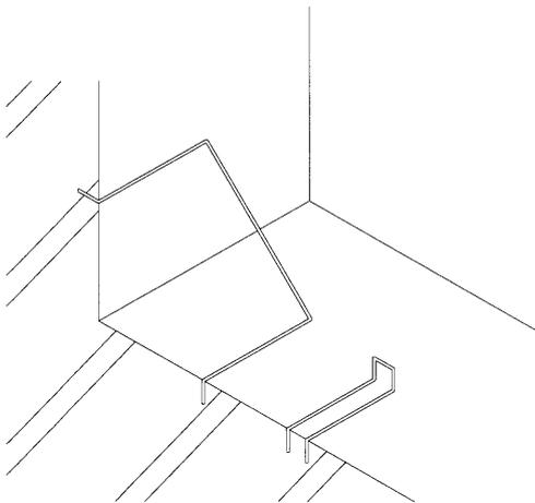
施工補助金具(矩形開口用)の一例
