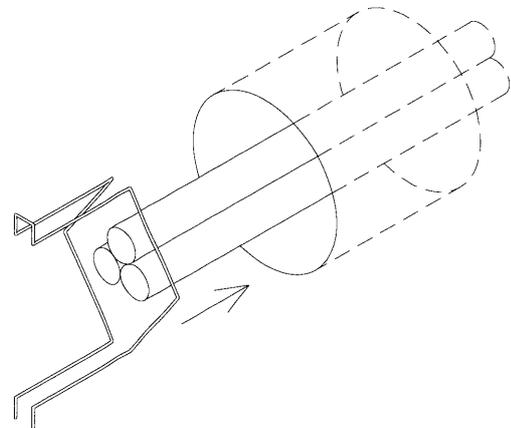
施工補助金具(円形開口用)の一例
