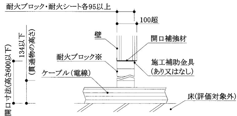
断面図(床置き工法の例)
