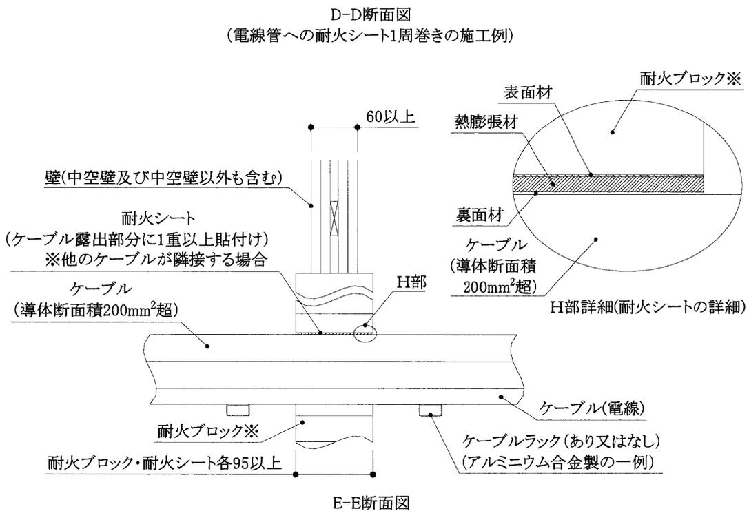
(他のケーブルが隣接する場合におけるケーブル(導体断面積200mm<sup>2</sup>超)と耐火シートの施工例)
