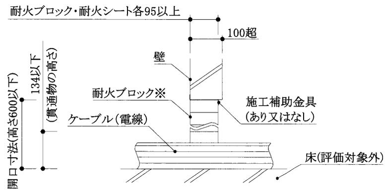
断面図(床置き工法の例)
