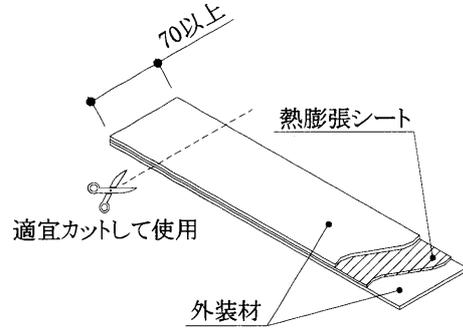
耐火ブロック用補助充填材詳細図の一例
