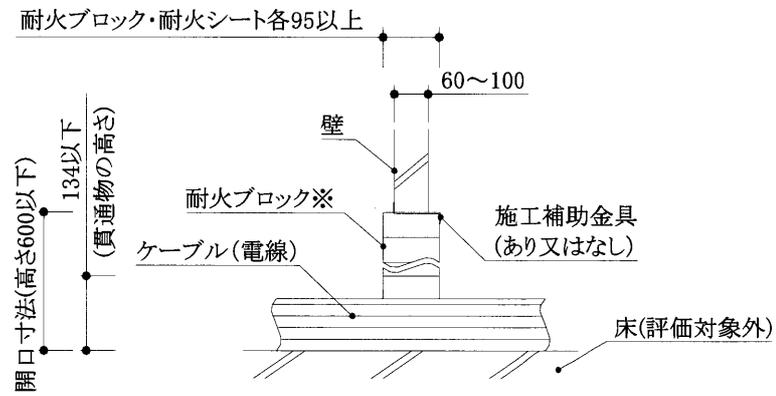
断面図(床置き工法の例)
