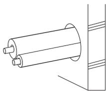
中空壁の場合、又は中空壁以外の壁で壁厚が100mm以下の場合は板厚0.25mm以上の鋼製スリーブ(金属板)を開口に設置してください。別売品「ラクスリーブ」や「イチジカン-丸穴スリーブ」を取りそろえております。
