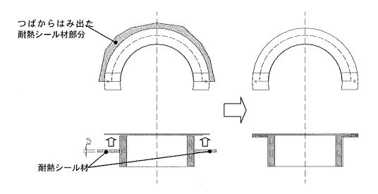
(7) (6) の耐熱シール材付樹脂スリーブを2つ用意し、貫通配管を挟んで嵌め合わせ、開口部を中心にして開口に設置する。
