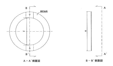
図3 固定金具の構造
