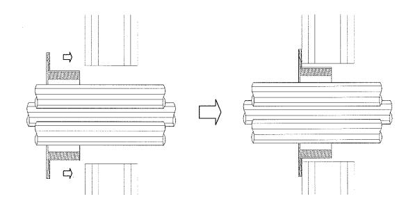
(8) 固定金具付樹脂スリーブを留付材で固定する。
