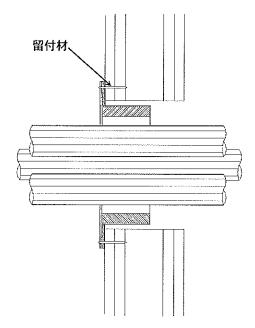
(9) 貫通配管等に高さ 50mm 位置にマーキングを行った後、固定金具内側から貫通配管等にかけて、マーキングが隠れる高さまで耐熱シール材を密に充てんし、その周囲に耐熱シール材固定用テープを1周巻き付ける。
