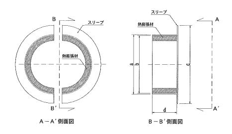
図2 樹脂スリーブの構造
