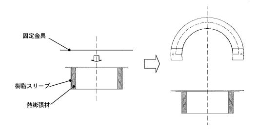
(6) (5) の固定金具付樹脂スリーブのつば裏側全面に、厚さ 5mm の耐熱シール材を充て、つばからは み出た耐熱シール材をカッターなどでカットして整え、取り付ける。
