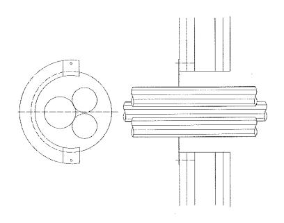
(5) 固定金具の内側を樹脂スリーブの内側に沿わすように合わせて取り付ける。
