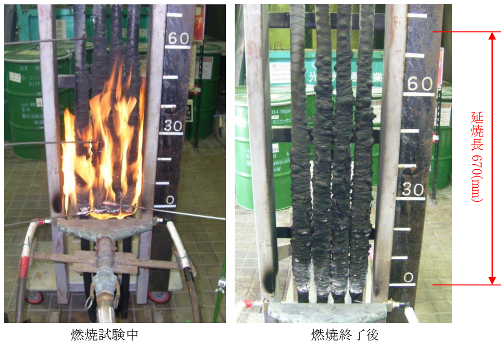
図-1 垂直トレイ燃焼試験
